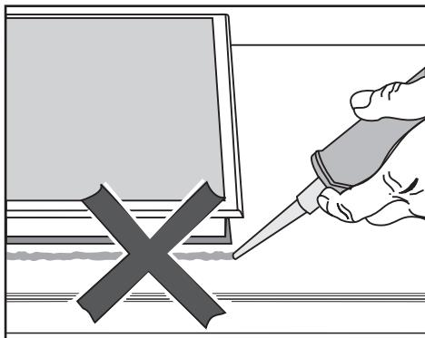
Уплотнитель под кромкой верхней части прибора обеспечивает необходимую герметичность между прибором и столешницей.
